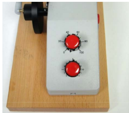
Figura 5: Reglarea pulsației \omega_{ext} a discului motor prin două potențiometre ( reglare brută și reglare fină)
